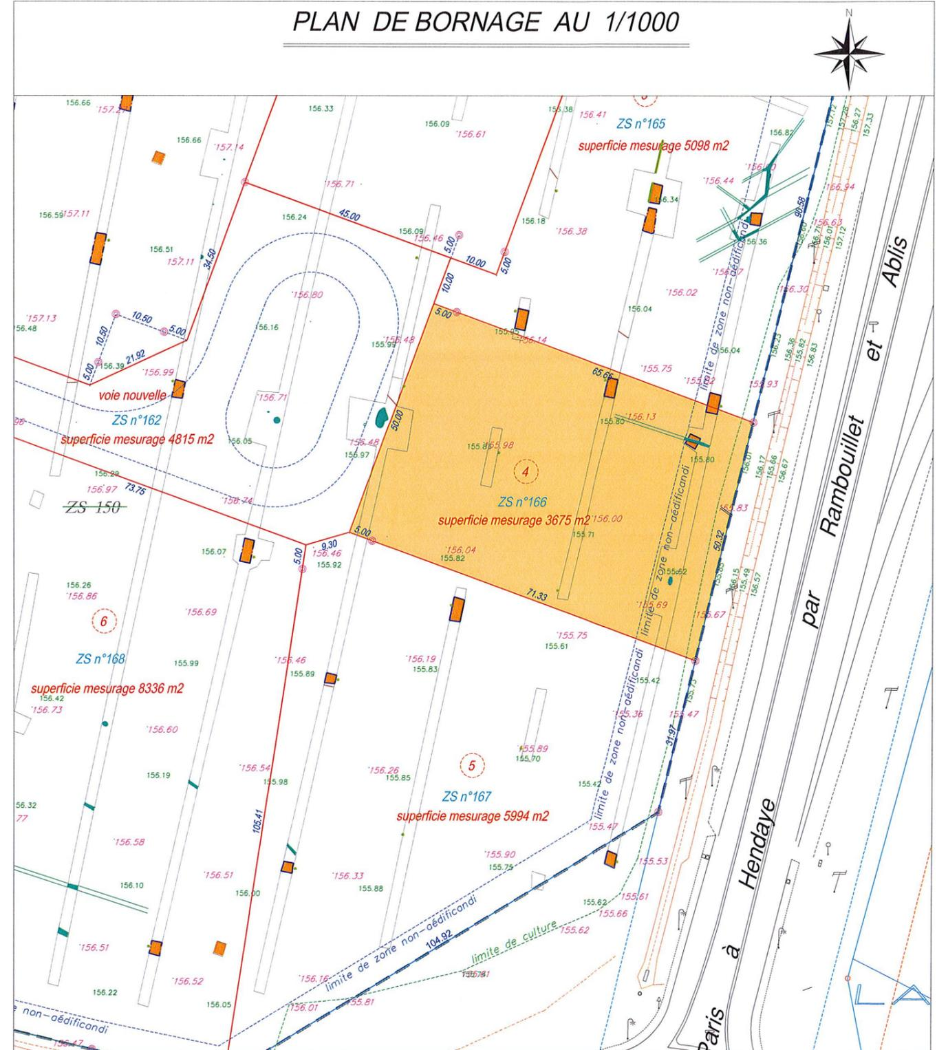
NOTA : Le plan topographique d'origine du site date de décembre 1995. Le terrain a été remblayé et une nouvelle topographie a été réalisée en mars 2014. Les points de niveau donnent une idée globale de la topographie à prendre avec précaution suite aux différents remblaiements du terrain.
