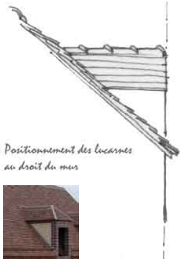
Lucarne neuve au-dessus de l'égout avec toit à croupe et traitement des jambages en brique.
