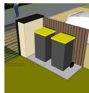
Dispositif de camouflage en bois + grave calcaire compactée au sol
